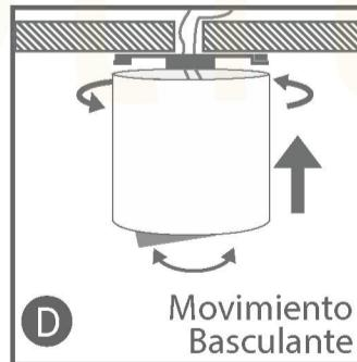
Lleve la bala GU10 hacia la placa y gírela hasta asegurarla. Dirccione el haz de luz con el sistema basculante hacia la posición deseada.
